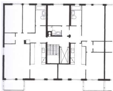
Skivhus – med hiss och mörkt trapphus.
